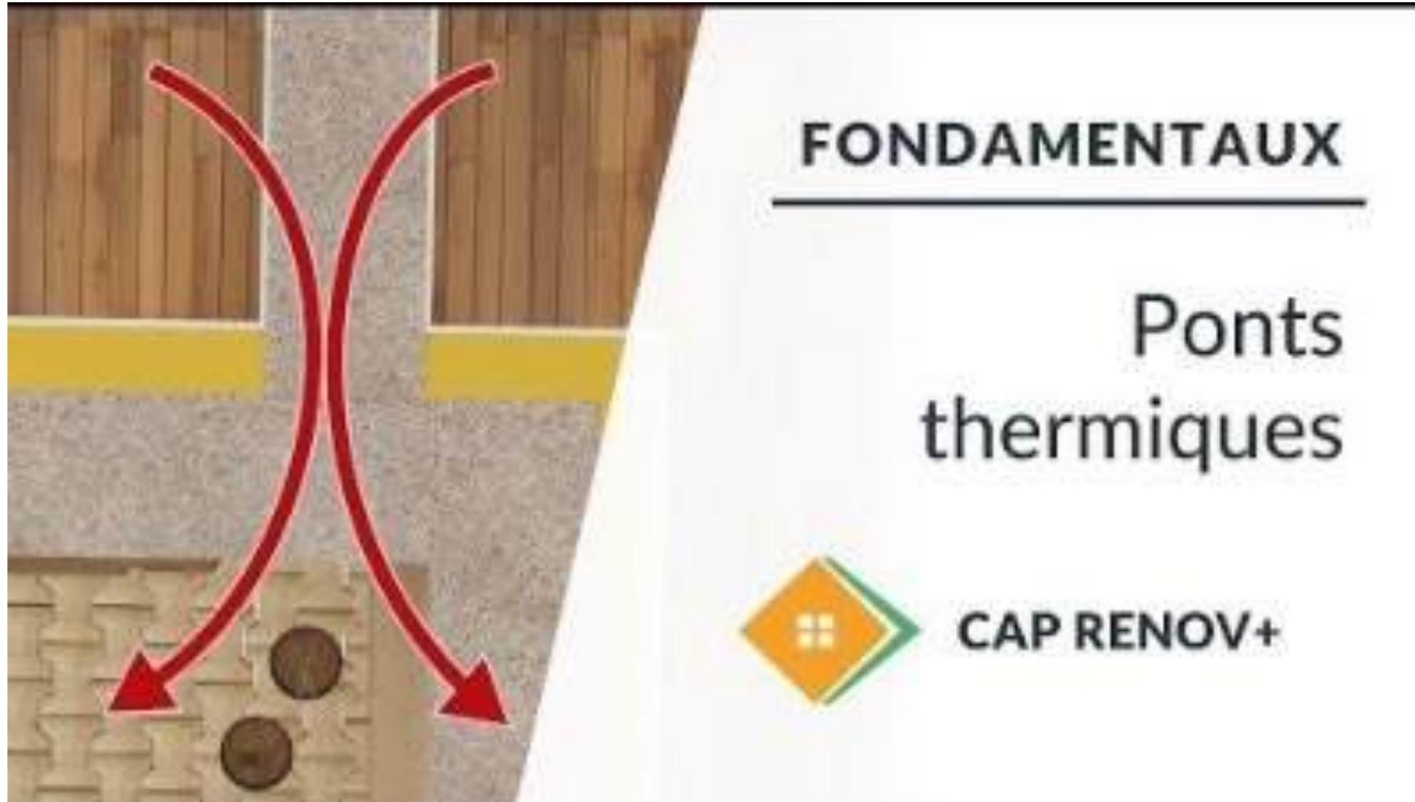
Définition : Un pont thermique est une rupture / discontinuité d'isolation.
